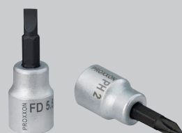
3/8" Bits med krydskærv, 50 mm Klinge af Krom-Silicium-Mangan-Molybdæn-Stål. Sokkel af CrV-Stål.
