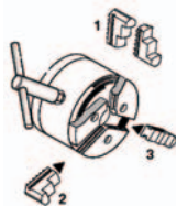
Fig. 4: Wenden bzw. tauschen der Backen
