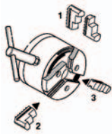
Fig. 4 : Retournement ou remplacement des mors
