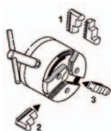
Fig. 4: Girare o sostituire le ganasce
