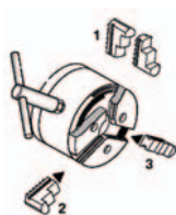
Fig. 4: Virar o bien sustituir las mordazas
