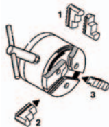
Fig. 4: Wenden bzw. tauschen der Backen
